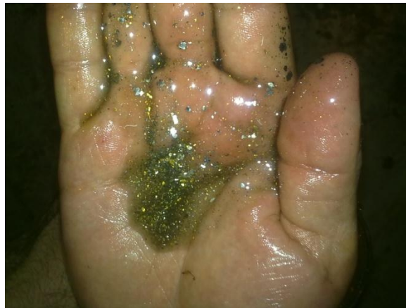
شکل ۹: ذرات فلزی موجود در روغن برگشتی از غلتک ۲
