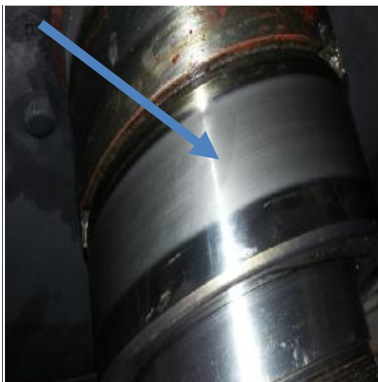
تصویر race داخلی بیرینگ موتور
