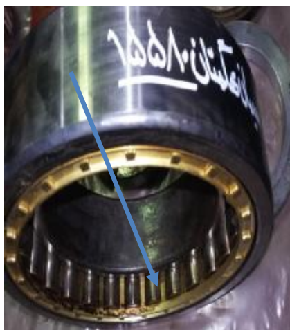
تصویر بیرینگ معیوب تعویض شده
